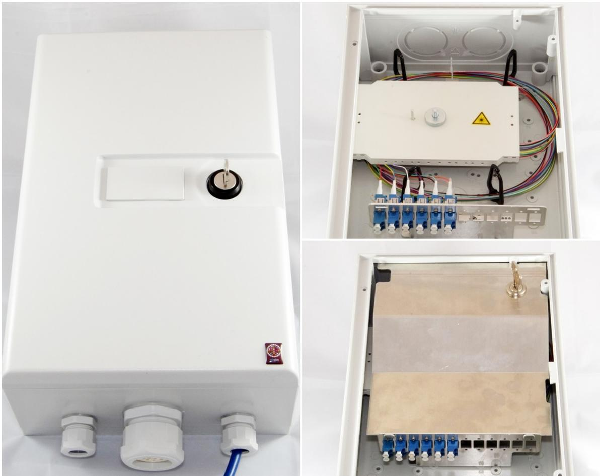
Die telebox FTTX 24F kann sowohl im Innen- als auch im Außenbereich eingesetzt werden. Sie erfüllt den Schutzgrad IP 54. Die Box ist abschließbar und bietet eine Aufnahme bis zu 24 LWL Stecker. Abgeschlossen werden können SC, LC und E-2000 Stecker in verschiedenen Bauformen. Für die Abdichtung der Patchkabel werden geteilte Abdichtungen eingesetzt. Es werden die folgenden Konfigurationen angeboten:
