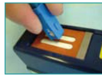
Trockene LWL-Steckerreinigung mit LWL-Reel-Cleaner
