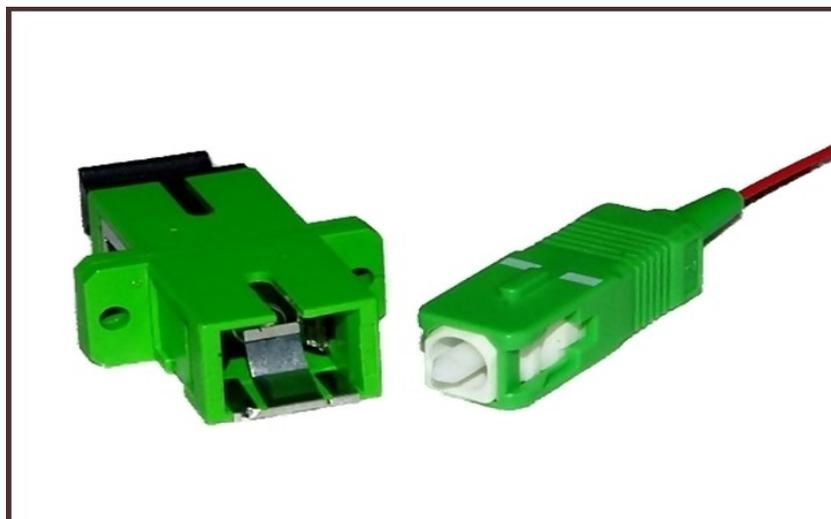
Der **SC-Stecker** ist ein LWL-Stecker, der sich als polarisierter Push/Pull-Stecker durch seine geringen Abmessungen und hohe Packungsdichte auszeichnet. Dieser LWL-Stecker hat ein quadratisches Design und kann für Multimodefasern und Monomodefasern benutzt werden. Mit dem Stecker können Simplex-, Duplex- und Mehrfachverbindungen aufgebaut werden. Der SC-Stecker ist in der Simplex-Ausführung im Standard IEC 61754-4 standardisiert, in der Duplex-Ausführung unter IEC 60874-19.
