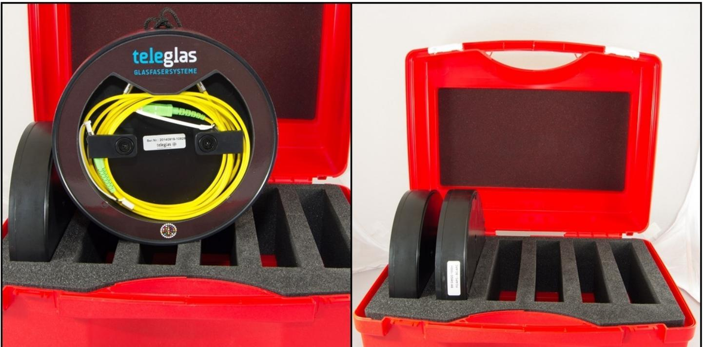
Wir bieten Ihnen Vorlauf-/Nachlauffasern als Mess-Box in unterschiedlichen Ausführungen an. Hochwertige Fasern und selektierte Stecker garantieren hervorragende optische Parameter.
